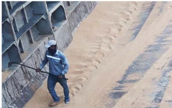
การเก็บท้องเรือ หรือการเก็บสินค้าที่เหลืออยู่ในช่วงขั้นตอนสุดท้ายของการขนถ่าย
